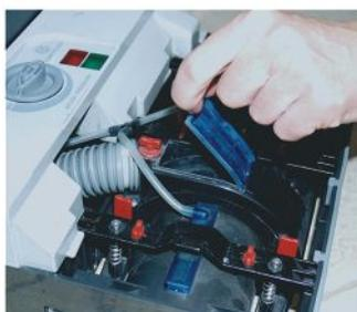
18. В случае засорения всасывающих трубок повернуть красную защёлку наверху контрольного окошка, снять его и прочистить трубки.
