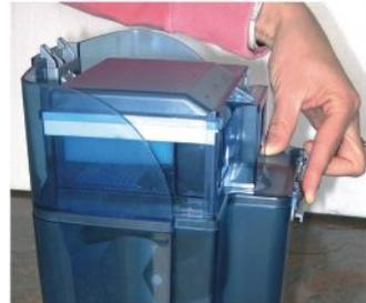
3. После установки верхней части бака совместить непрерывную линию с нижней частью и защёлкнуть заднее крепление.
