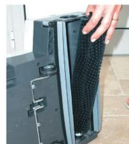
20. Снять крепления и вытянуть щётку.
